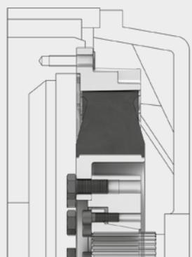
Struttura costruttiva AC...F2 con bussola di serraggio dentata
