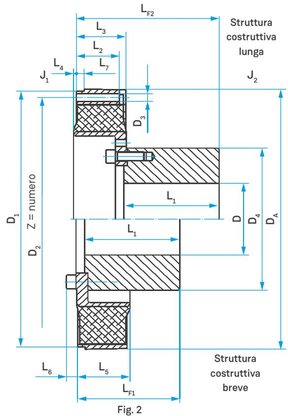
🔄 Grazie alla possibilità del montaggio reciproco dell'elemento del giunto, con lo stesso mozzo di accoppiamento risultano due diverse lunghezze di montaggio.
