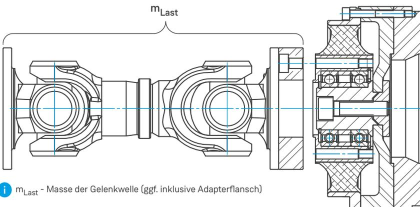
**i** m<sub>Last</sub> - Masse der Gelenkwelle (ggf. inklusive Adapterflansch)
